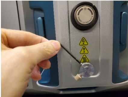
Abbildung 3-7: Festziehen der unverlierbaren Schraube
