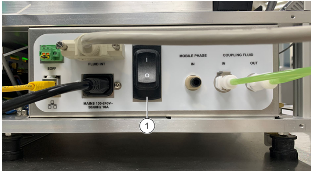
Figura 4-2 Interruptor de corriente del módulo Echo® MS
