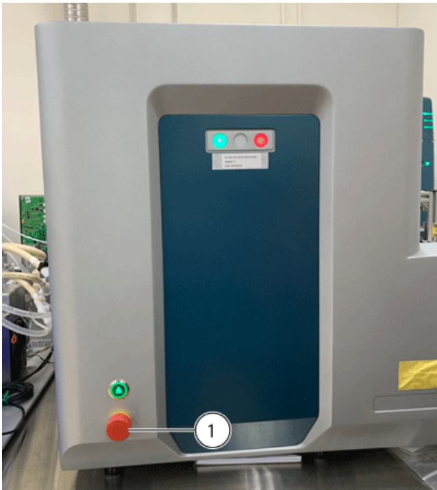
Figura 6-2 Botón de apagado de emergencia en el panel frontal del módulo Echo® MS
