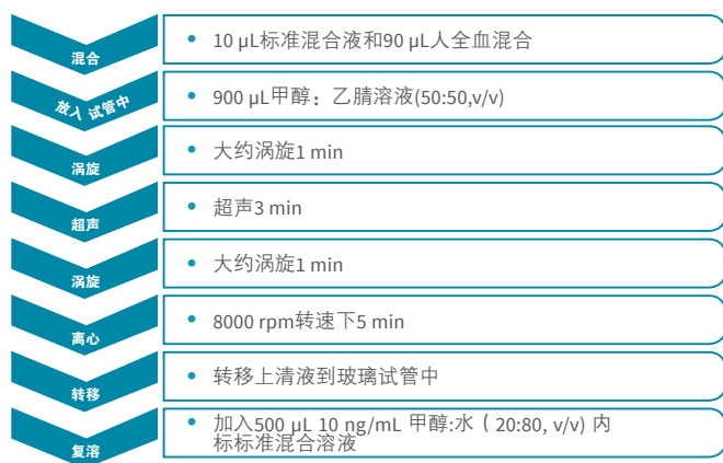
图2. 人全血样品的蛋白沉淀前处理流程。采用9步蛋白质沉淀法从人全血样本中选择性提取待分析物，并使用SCIEX Triple Quad 7500系统进行分析
